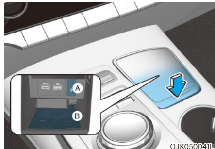
[A]: Kontrollleuchte, [B]: Ladekissen
