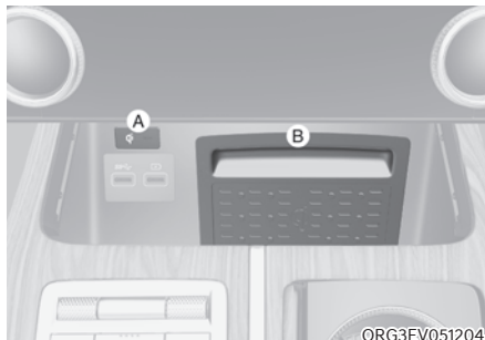
[A]: Kontrollleuchte, [B]: Ladekissen
