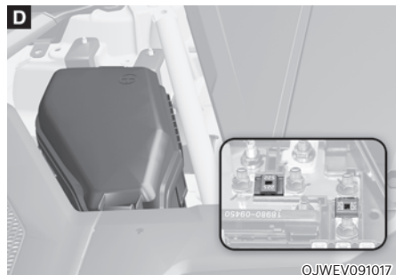
[C]: Mehrfachsicherung, [D]: Midi-Sicherung
