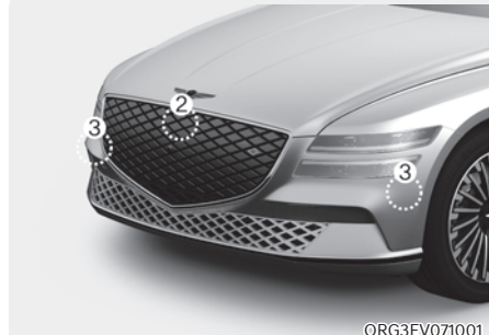
[1]: Frontkamera, [2]: Frontradar [3]: Eckradar vorn (ausstattungsabhängig),
