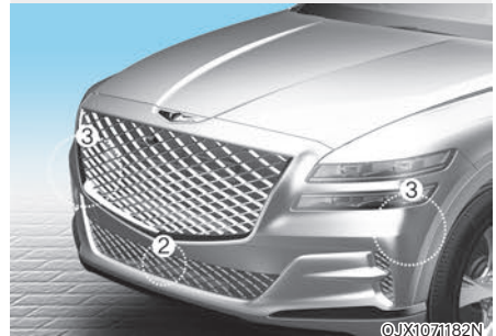
[1]: Frontkamera, [2]: Frontradar [3]: Eckradar vorn (ausstattungsabhängig)
