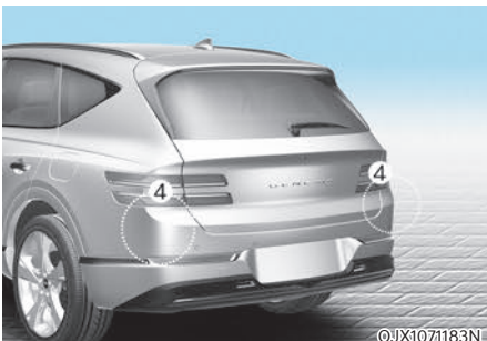
[1] : Frontkamera, [2]: Frontradar, [3]: Eckradar vorn (ausstattungsabhängig), [4] : Eckradar hinten
