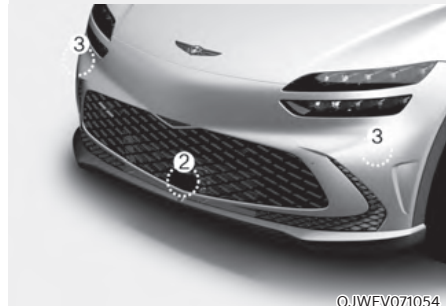
[1]: Frontsichtkamera, [2]: Frontradar [3]: Eckradar vorn (ausstattungsabhängig)
