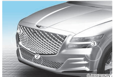
[1]: Frontkamera, [2]: Frontradar [3]: Eckradar vorn (ausstattungsabhängig)
