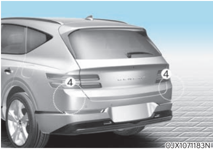
[1] : Frontkamera, [2]: Frontradar, [3]: Eckradar vorn (ausstattungsabhängig), [4]: Eckradar hinten
