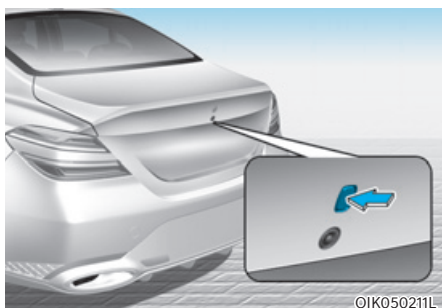
Contacteur d'ouverture de coffre électrique (2)
