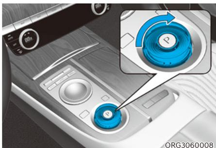
Pour sélectionner la position D (Conduite), tournez le sélecteur rotatif dans le sens des aiguilles d'une montre tout en enfonçant la pédale de frein.
