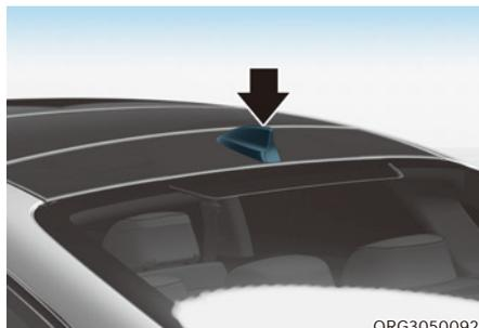
L'antenne en aileron de requin permet de recevoir les émissions AM, FM et de transmettre des données.
