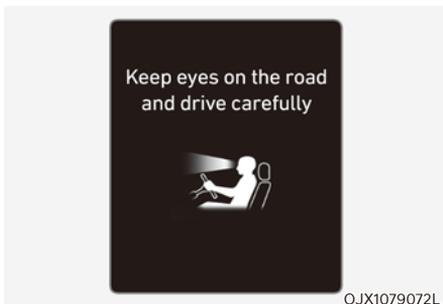
L'avertissement d'attention du conducteur détermine si le conducteur est concentré sur la route, comme le temps passé à regarder ailleurs, la durée de fermeture des yeux, la fréquence des bâillements, etc. Si le système estime que le conducteur n'est pas concentré, le message d'avertissement 'Keep eyes on the road and drive careful (Gardez les yeux sur la route et conduisez prudemment)' apparaîtra dans le combiné d'instruments et un signal sonore retentira.
