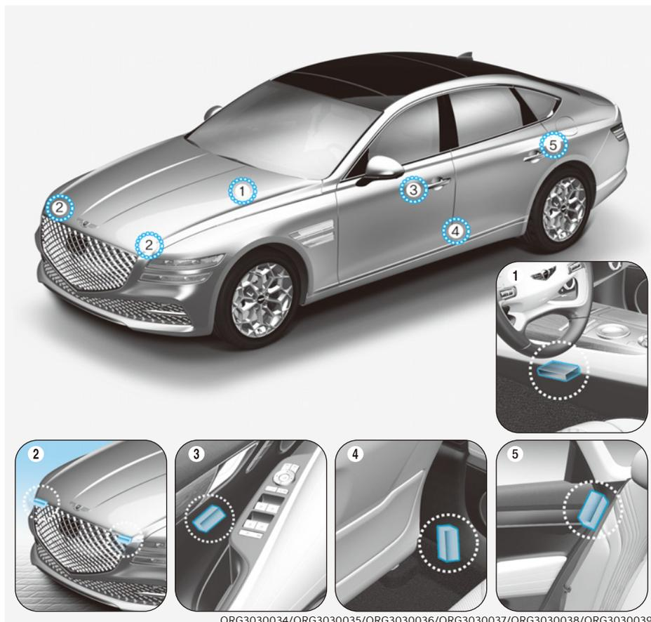
1. Module de commande SRS/Capteur de retournement
