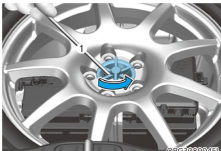
Si vous avez du mal à dévisser le boulon papillon de maintien de la roue à la main, vous pouvez le desserrer facilement à l'aide de la clé de goujon. Tournez le boulon papillon de maintien de la roue dans le sens antihoraire à l'aide de la clé de goujon.
