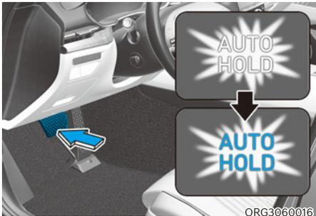
2. Lorsque vous arrêtez complètement le véhicule en enfonçant la pédale de frein, la fonction Auto Hold maintient la pression de freinage pour maintenir le véhicule à l'arrêt. Le voyant passe du blanc au vert.
