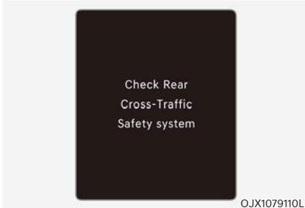
Lorsque le système de sécurité de circulation transversale à l'arrière ne fonctionne pas correctement, le message 'Check Rear Cross-Traffic Safety system (Vérifiez le système de sécurité de circulation transversale à l'arrière)' apparaît dans le combiné d'instruments et le système se désactive automatiquement, ou il sera limité. Nous vous conseillons de faire inspecter le système par un concessionnaire Genesis agréé.
