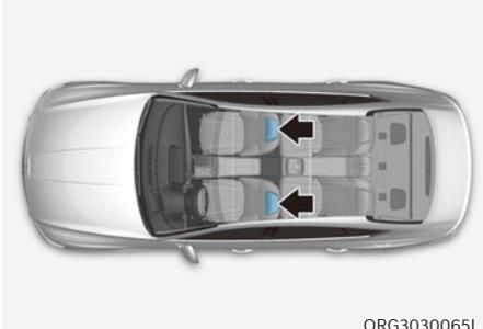
Les sièges conducteur et passager avant sont équipés d'appuie-têtes réglables pour le confort et la sécurité des passagers.
