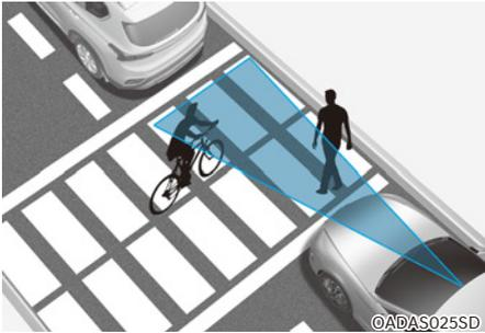
Si'il y a un ou plusieurs piétons ou vélos entre vous et le véhicule devant, l'alerte de démarrage du véhicule de tête peut ne pas fonctionner correctement.
