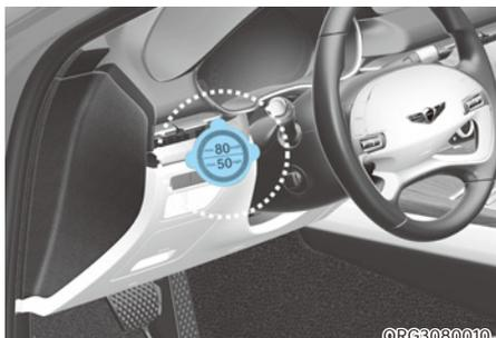
Retirez l'étiquette de limitation de vitesse (0) de la bouteille de produit d'étanchéité (1) et placez-la à un endroit bien visible à l'intérieur du véhicule, par exemple sur le volant, pour rappeler au conducteur de ne pas conduire trop vite.
