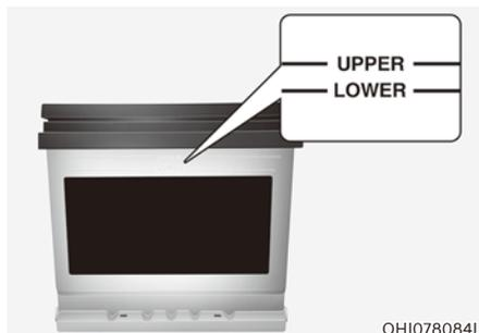
Si votre véhicule est équipé d'une batterie qui affiche les repères UPPER (MAX) et LOWER (MIN) sur le côté, il convient de vérifier le niveau d'électrolyte.
