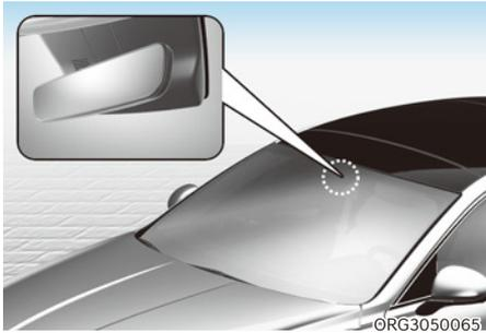
Le désembuage automatique réduit la possibilité de formation de buée à l'intérieur du pare-brise en détectant automatiquement l'humidité à l'intérieur du pare-brise.
