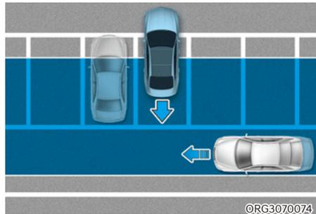
Le système de sécurité de circulation transversale à l'arrière peut détecter les véhicules qui passent derrière vous lorsque vous vous gardez en marche arrière dans un emplacement. Si cela se produit, le système peut avertir inutilement le conducteur et intervenir sur les freins.
