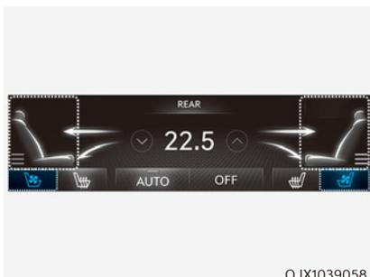
Vous pouvez également régler des débits d'air différents pour les sièges avant et arrière. Quand le moteur tourne, touchez l'icône de ventilation de siège sur l'écran du système de commande de température.
