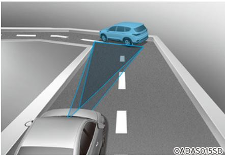
La vitesse de votre véhicule peut être réduite à cause d'un véhicule dans la voie adjacente.
