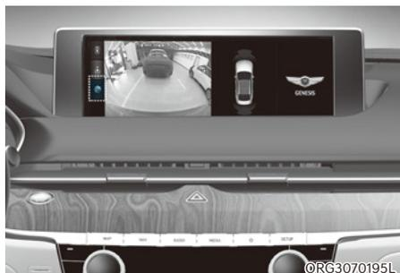
Vous pouvez modifier les paramètres de la caméra de recul en appuyant sur l'icône de configuration (⚙️) sur l'écran lorsque le système fonctionne ou sélectionnez 'Driver Assistance → Parking Safety → Camera Settings' dans le menu Réglages lorsque le bouton de démarrage/d'arrêt du moteur est en position ON.
