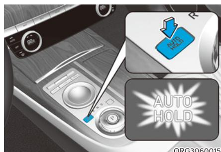
1. Lorsque la portière du conducteur et le capot moteur sont fermés, enfoncez la pédale de frein, puis sur le commutateur AUTO HOLD. Le témoin blanc AUTO HOLD s'allume et le système est en position de veille.
