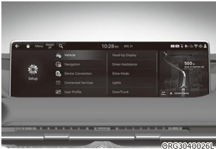
Les réglages du véhicule dans le système d'info-divertissement offrent à l'utilisateur une multitude d'options, notamment des fonctions pour le verrouillage/déverrouillage de portes, des fonctions de confort, des réglages d'assistance à la conduite, etc.
