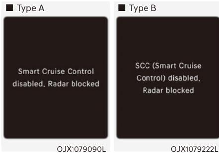
Lorsque le cache du radar avant ou le détecteur est recouvert de neige, de pluie ou de corps étrangers, il peut réduire les performances de détection et limiter ou désactiver temporairement le régulateur de vitesse adaptatif.
