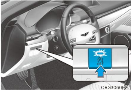
Quand le système est désactivé, le témoin de désactivation du système ISG s'allume et le message "Erreur Arrêt auto. Passer sur P ou N pour démarrage manuel du moteur." s'affiche sur le LCD du combiné avec un son d'avertissement.
