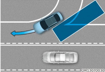
Le système de sécurité d'angle mort peut ne pas fonctionner correctement lorsque des voies fusionnent ou se séparent. Le système peut ne pas détecter le véhicule dans la voie adjacente.
