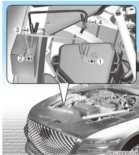
6. Raccordez les câbles volants dans l'ordre exact indiqué sur l'illustration. Branchez une extrémité du câble volant à la borne de secours positive (+) rouge de votre véhicule (1).
