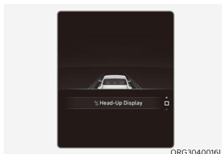
Quand le menu Aff. tête haute est sélectionné, appuyez sur le commutateur OK au volant. Vous pouvez sélectionner ou désélectionner l'affichage tête haute en appuyant sur le commutateur OK.
