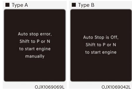
**Erreur Arrêt auto. Réglez le levier sur P ou N pour démarrer manuellement / Arrêt auto désactivé. Réglez le levier sur P ou N pour démarrer**
