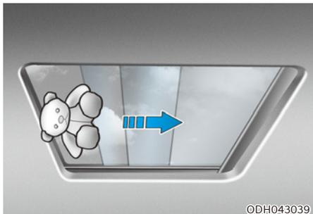
Si le toit ouvrant détecte un obstacle pendant la fermeture automatique, il inverse le sens et s'arrête pour permettre de dégager l'objet.
