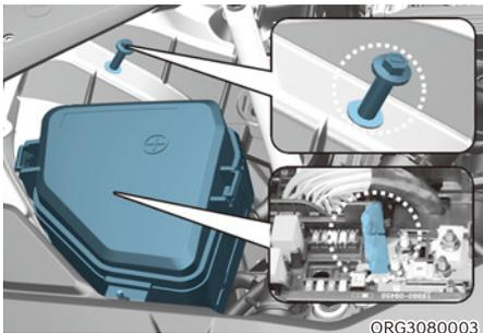
5. Déposez le couvercle de la boîte de fusible du compartiment moteur.
