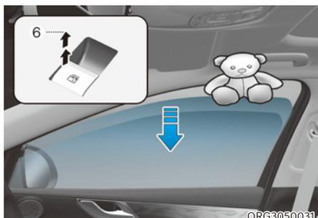
Si une vitre détecte un obstacle pendant qu'elle se ferme automatiquement, elle s'arrête et s'abaisse d'environ 30 cm (12 po) pour permettre de retirer l'objet.
