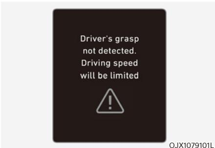
Lorsque l'assistance à la conduite sur autoroute est annulée par l'avertissement de mains hors du volant, la vitesse de conduite est limitée.
