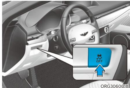
Le contrôle électronique de stabilité (ESC) assure la stabilité de votre véhicule dans les virages. L'ESC vérifie l'angle de braquage et la trajectoire du véhicule.
