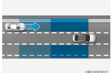
L'assistance à l'évitement de collision en angle mort aide à détecter et informer le conducteur qu'un véhicule s'approche à vive allure de la zone d'angle mort.
