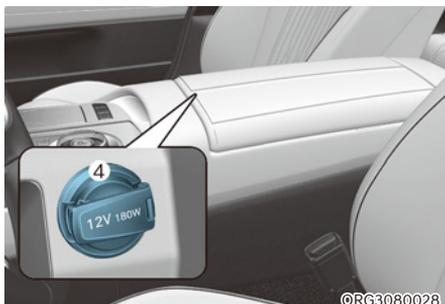
7. Connecter le compresseur à la prise de courant du véhicule en utilisant le câble et les connecteurs (4).
