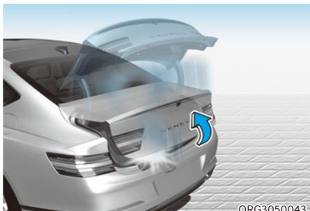
Si, lors de l'ouverture ou de la fermeture électrique, le coffre est bloqué par un objet ou un membre d'une personne, le coffre électrique détecte la résistance et arrête le mouvement ou revient en position complètement ouverte afin que l'objet ou le membre puisse être retiré.
