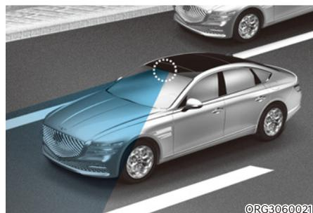
La caméra frontale est un capteur qui détecte la route devant le véhicule. Si le pare-brise ou la caméra avant est recouvert(e) par de la neige, la pluie ou un corps étranger, les données récoltées par la caméra sont réduites vu la dégradation des performances de la caméra. Veillez à ce que la caméra frontale soit toujours propre.
