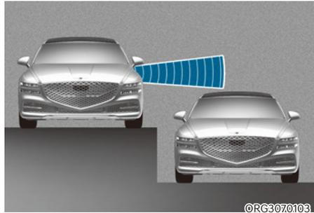
Le système de sécurité d'angle mort risque de ne pas fonctionner correctement lorsque les voies ont des hauteurs différentes. Le système peut ne pas détecter le véhicule sur une route ayant des hauteurs de voie différentes (jonction d'un passage inférieur, intersections à niveaux séparés, etc.).
