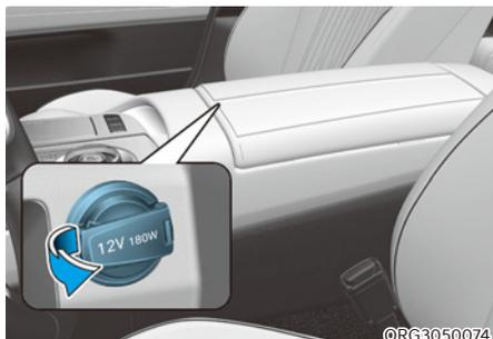
La prise de courant permet d'alimenter des téléphones portables ou d'autres appareils conçus pour fonctionner avec les systèmes électriques du véhicule. Ces appareils doivent consommer moins de 180 W (Watts) quand le moteur tourne.
