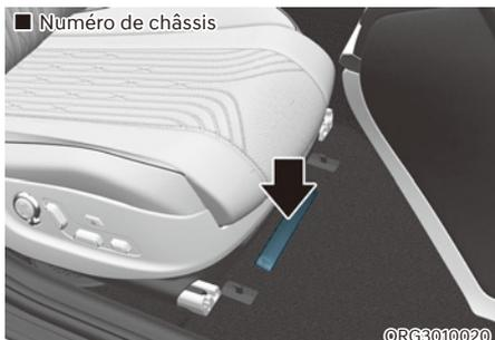
Le numéro d'identification du véhicule (VIN) est le numéro utilisé pour immatriculer votre véhicule et pour toutes les démarches légales associées à sa propriété, etc.
