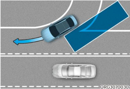
Le système de sécurité d'angle mort peut ne pas fonctionner correctement lorsque des voies fusionnent ou se séparent. Le système peut ne pas détecter le véhicule dans la voie adjacente.
