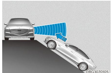
Le système de sécurité de circulation transversale à l'arrière peut être limité lorsque le véhicule est dans une montée ou une descente ou s'en approche, et peut ne pas détecter le véhicule s'approchant par la gauche ou la droite. Si c'est le cas, le système peut ne pas avertir le conducteur lorsque cela est nécessaire.
