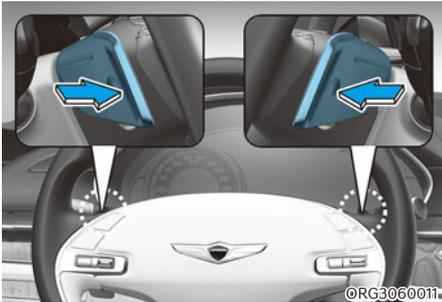
La manette de changement de vitesse permet au conducteur de changer de vitesse en gardant les mains sur le volant.
