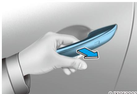
Pour déverrouiller votre véhicule à l'aide du capteur tactile de la poignée de porte ou la clé intelligente :
