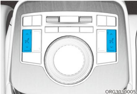
Appuyez sur l'interrupteur de commande pour faire glisser le siège à la position souhaitée. L'angle du dossier est ajusté automatiquement avec la position coulissante du siège.
