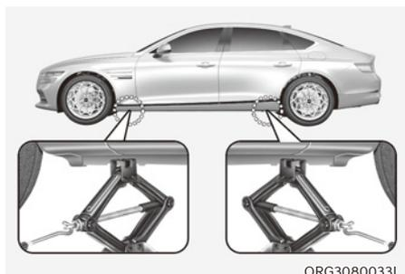
7. Placez le cric à la position de levage indiquée sous le châssis, le plus près du pneu que vous changez. Les positions du cric sont les plaques soudées au châssis avec deux encoches. Ne mettez jamais le cric à un autre emplacement ou une autre partie du véhicule. Cela pourrait endommager les moulures latérales ou d'autres pièces du véhicule.
