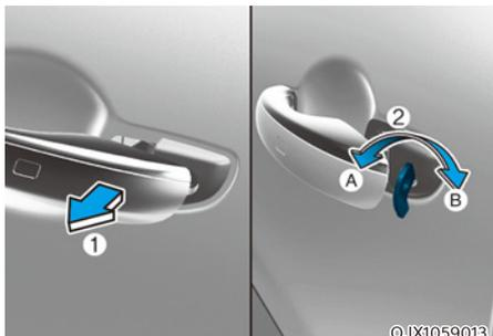
Après avoir tiré la poignée de porte (1), tournez la clé (2) vers l'avant du véhicule pour verrouiller (A) ou tournez la clé vers l'arrière du véhicule pour déverrouiller (B).
