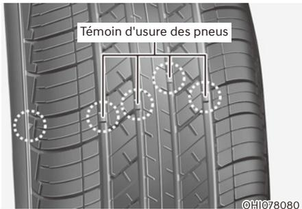
Si le pneu est usé uniformément, un indicateur d'usure de la bande de roulement apparaîtra sous la forme d'une bande pleine sur la bande de roulement. Cela indique qu'il reste moins de 1,6 mm (1/16 po) de bande de roulement sur le pneu. Remplacer le pneu lorsque cela se produit.
