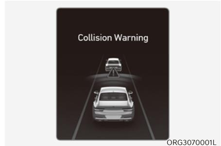
Pendant le fonctionnement du régulateur de vitesse adaptatif, lorsque le risque de collision avec le véhicule devant est élevé, le message 'Collision Warning (Risque de collision)' apparaît dans le combiné d'instruments et un signal sonore retentit pour alerter le conducteur. Regardez toujours devant vous lorsque vous conduisez et appuyez sur la pédale de frein si nécessaire pour réduire votre vitesse et garder une distance de sécurité.
