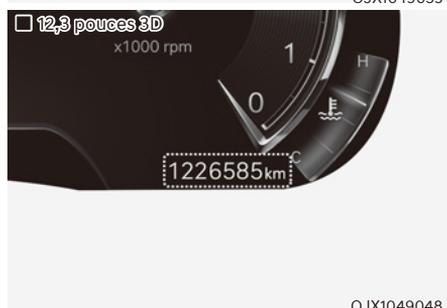
Le compteur kilométrique indique la distance totale parcourue par le véhicule et doit être utilisé pour déterminer à quel moment la maintenance périodique doit être effectuée.
