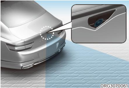
La caméra de recul est utilisée comme un détecteur pour repérer les piétons. Si la lentille de la caméra est recouvert de corps étrangers (neige, pluie...), cela peut nuire aux performances de la caméra et le freinage d'urgence autonome en marche arrière pourrait ne pas fonctionner normalement. Veillez à ce que la lentille de la caméra soit toujours propre.
