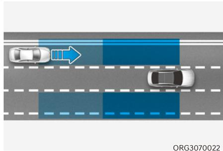
Le système d'avertissement de collision d'angle mort aide à détecter et informer le conducteur qu'un véhicule s'approche à vive allure de la zone d'angle mort.
