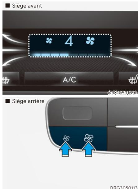
La vitesse du ventilateur peut être réglée sur la vitesse souhaitée en touchant l'icône
