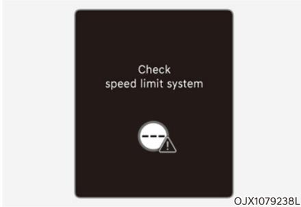
Lorsque l'assistance intelligente de limite de vitesse ne fonctionne pas correctement, le message d'avertissement « Check speed limit system » (Vérifier le système de limite de vitesse) apparaît sur le combiné d'instruments. Dans ce cas, nous vous recommandons de faire inspecter le système par un concessionnaire Genesis agréé.
