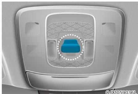
Le toit ouvrant ne peut être ouvert, fermé ou incliné que lorsque le bouton de démarrage/arrêt du moteur est en position ON.
