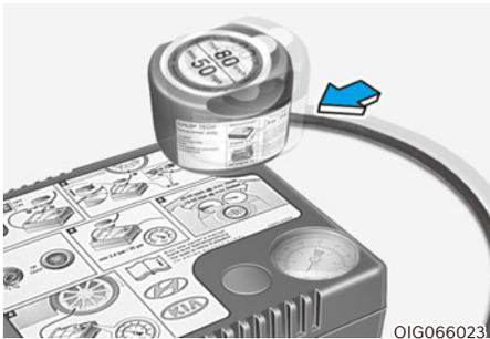
4. Introduisez la bouteille de produit d'étanchéité en position verticale dans le logement du compresseur (4).
