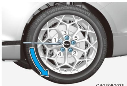
6. Desserrez les boulons de roue d'un tour dans le sens antihoraire en suivant l'ordre indiqué ci-dessus, mais ne les retirez pas tant que le pneu n'est pas surélevé.
