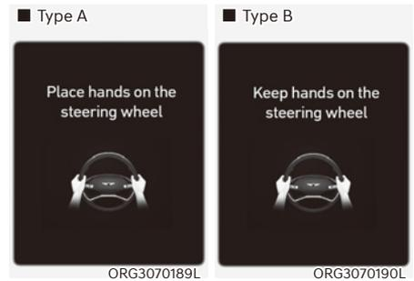
Si le conducteur retire ses mains du volant pendant plusieurs secondes, le message 'Place hands on steering wheel (Remettez les mains sur le volant)' (ou 'Keep hands on steering wheel (Gardez les mains sur le volant)') apparaîtra et un signal sonore retentira par phases.
