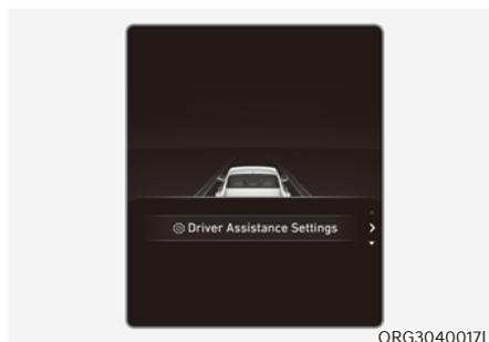
Quand le menu Paramètres du système d'assistance au conducteur est sélectionné, appuyez sur le commutateur OK au volant. Le menu 'Assistance cond.' s'affiche à l'écran du menu d'info-divertissement.
