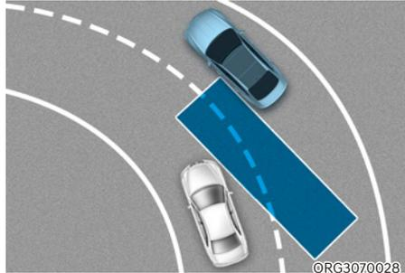
Le système de sécurité d'angle mort peut ne pas fonctionner correctement lorsque vous conduisez sur une route sinueuse. Le système peut ne pas détecter le véhicule dans la voie adjacente.
