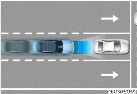
L'aide à l'évitement de collision avant est conçue pour détecter et surveiller le véhicule qui précède ou détecter un piéton ou un cycliste sur la chaussée et avertir le conducteur qu'une collision est imminente par un message d'avertissement et un signal sonore, et éventuellement, en amorçant un freinage d'urgence.
