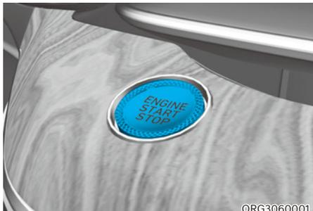
Lorsque la porte avant est ouverte, le bouton de démarrage/arrêt du moteur s'éclaire et s'éteint 30 secondes après la fermeture de la porte.
