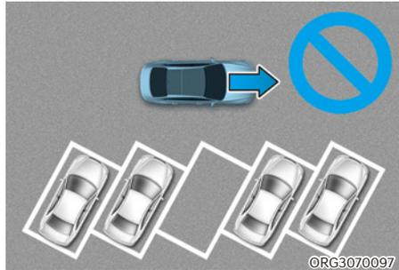
L'aide au stationnement intelligent à distance ne permet pas le stationnement en diagonale. Même si votre véhicule a pu entrer dans la place de stationnement, n'utilisez pas le système car celui-ci risque de ne pas fonctionner normalement.
