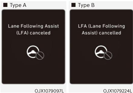
Si le conducteur n'a toujours pas les mains sur le volant après le rappel, le message 'Lane Following Assist (LFA) canceled (Assistance active au suivi de voie annulée)' (ou 'LFA (Lane Following Assist) cancelled') apparaîtra et l'assistance au suivi de voie sera automatiquement annulée.
