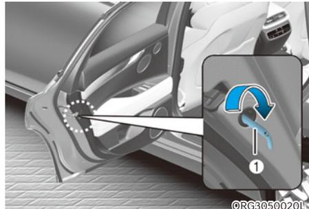
Les verrous de sécurité enfants permettent d'empêcher les enfants assis à l'arrière d'ouvrir accidentellement les portes arrière. Le verrou de sécurité des portes arrière doit toujours être utilisé lorsque des enfants sont dans le véhicule.
