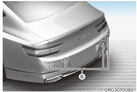
[A] : Caméra de recul, [B] : Capteurs ultrasons arrière
