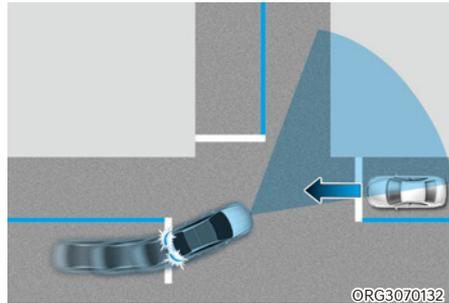
La fonction de virage aux croisements permet d'éviter une collision avec un véhicule venant en sens inverse dans un carrefour quand le clignotant est activé, en amorçant un freinage d'urgence.
