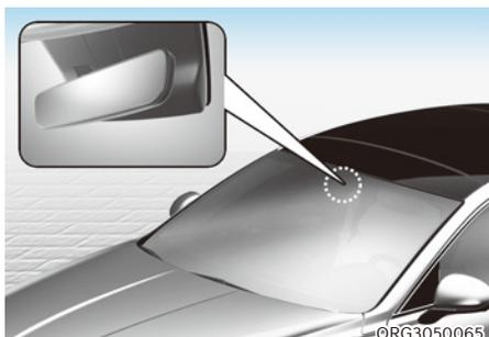
Le capteur de pluie situé à l'extrémité supérieure de la vitre du pare-brise détecte l'importance de la pluie et commande le cycle de balayage pour un intervalle approprié.
