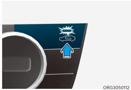
Le bouton de commande d'admission d'air sert à sélectionner le mode air Frais (air extérieur) ou le mode Recirculation (air de l'habitacle).
