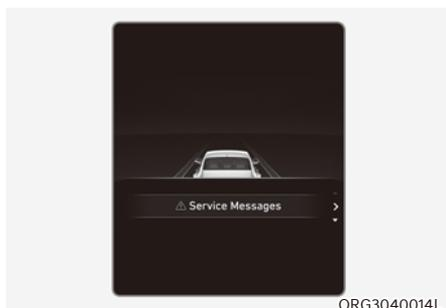
Quand le menu Notification de services est sélectionné, appuyez sur le commutateur OK au volant pour vérifier les messages d'avertissement du véhicule.
