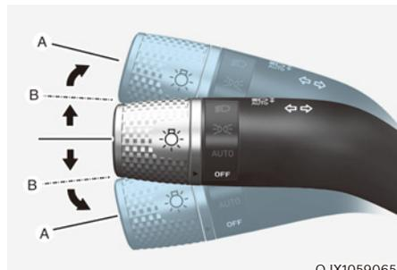
Pour signaler un changement de direction, appuyez sur le levier pour tourner à gauche ou soulevez-le pour tourner à droite en position (A).
