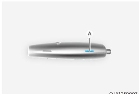
1. Placez un chiffon doux sur la rainure (A) et à l'aide d'un tournevis à tête plate, ouvrez le couvercle de la clé intelligente.
