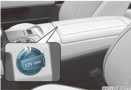
6. Branchez le cordon d'alimentation du compresseur (3) dans la prise de courant du véhicule.
