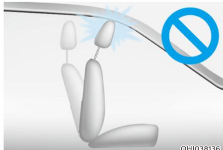
**Si vous inclinez le dossier vers l'avant avec l'appuie-tête et l'assise relevés, l'appuie-tête peut entrer en contact avec le pare-soleil ou d'autres parties du véhicule.**
