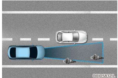
Dans les cas suivants, certains véhicules sur votre voie ne peuvent pas être détectés par le capteur :
