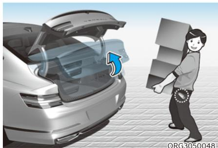
Sur un véhicule équipé d'une clé intelligente, le coffre peut être ouvert par une activation mains libres à l'aide du système de coffre intelligent.
