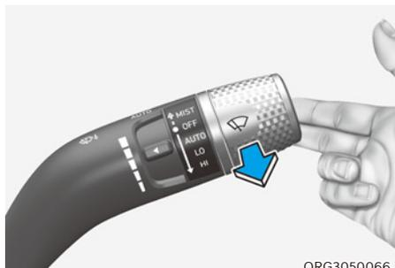
En position OFF (O), tirez doucement le levier vers vous pour pulvériser du liquide lave-glace sur le pare-brise et pour actionner les essuie-glaces pendant 1 à 3 cycles. La pulvérisation et les essuie-glaces continuent à fonctionner jusqu'à ce que vous relâchiez le levier. Si le lave-glace ne fonctionne pas, il est peut-être nécessaire d'ajouter du liquide dans le réservoir de lave-glace.
