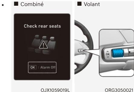
Si vous ne souhaitez pas utiliser l'alerte d'occupant arrière, appuyez sur le bouton OK du volant lorsque la première alerte s'affiche sur le combiné d'instruments. Cela désactivera une fois la deuxième alerte.
