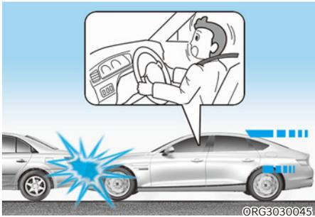
Lors de certaines collisions à faible vitesse, les airbags peuvent ne pas se déployer. Les airbags sont conçus pour ne pas se déployer dans ce genre de collisions, car ils n'apporteraient pas de sécurité supplémentaire par rapport à celle offerte par les ceintures de sécurité.
