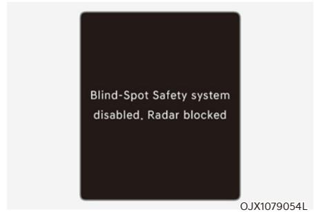
Lorsque le pare-chocs arrière autour du radar d'angle arrière ou du détecteur est recouvert de corps étrangers, comme de la neige ou de la pluie, ou lorsqu'on attache une remorque ou un porte-vélos, cela peut réduire les performances de détection et limiter ou désactiver temporairement le système de sécurité d'angle mort.
