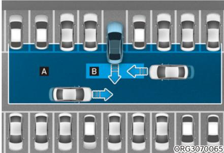
[A] : Plage de fonctionnement du système d'alerte de circulation transversale à l'arrière
