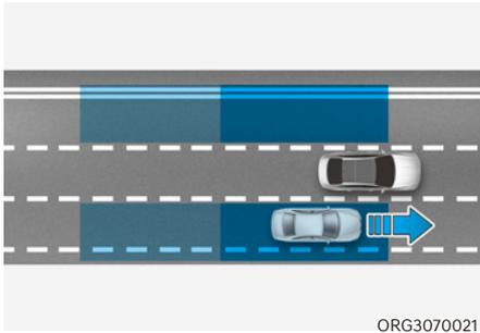
L'assistance d'évitement de collision d'angle mort aide à détecter et informer le conducteur qu'un véhicule se trouve dans l'angle mort.
