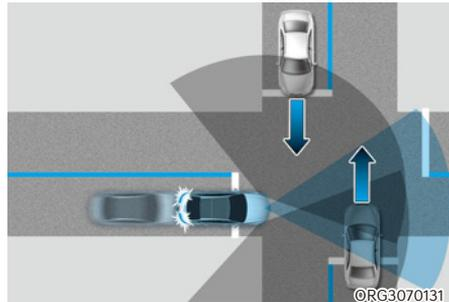
La fonction de traversée de croisement permet d'éviter une collision avec des véhicules venant en sens inverse à gauche ou à droite lors de la traversée d'un carrefour en amorçant un freinage d'urgence.
