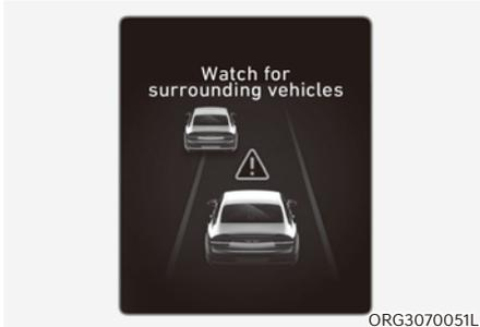
Dans la situation suivante, le message 'Watch for surrounding vehicles (Attention aux véhicules alentours)' apparaîtra dans le combiné d'instruments et un signal sonore retentira pour avertir le conducteur des conditions de circulation devant lui.
