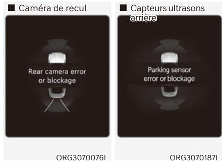
Le message 'Rear camera error or blockage' (Erreur ou blocage de la caméra de recul) ou 'Parking sensor error or blockage' (Erreur ou blocage des capteurs de stationnement) apparaîtra dans le combiné d'instruments si les situations suivantes se produisent :
