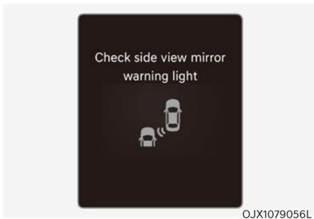
Lorsque le témoin du rétroviseur extérieur ne fonctionne pas correctement, le message 'Check side view mirror warning light (Vérifiez le témoin du rétroviseur extérieur)' apparaît dans le combiné d'instruments. Nous vous conseillons de faire inspecter le système par un concessionnaire Genesis agréé.
