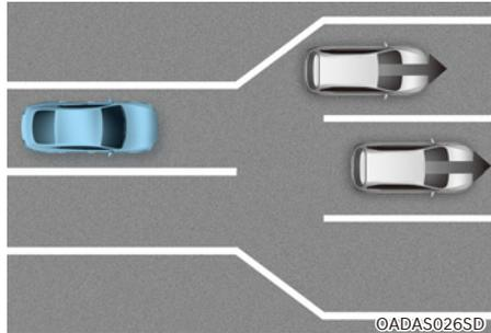
Si vous passez un péage ou un carrefour avec beaucoup de véhicules ou si vous roulez où les voies fusionnent ou se divisent régulièrement, l'alerte de démarrage du véhicule de tête peut ne pas fonctionner correctement.
