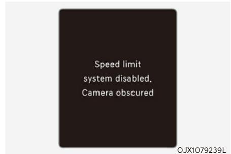
Lorsque le pare-brise où se trouve la caméra avant est couvert d'un corps étranger comme de la neige ou de la pluie, cela peut réduire les performances de détection et limiter ou désactiver temporairement l'assistance intelligente de limite de vitesse. Dans ce cas, le message « Speed limit system disabled. Camera obscured (Avertissement d'attention du conducteur désactivé. Caméra obstruée) » apparaîtra dans le combiné d'instruments.
