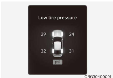
Lorsque les témoins d'avertissement du système de surveillance de la pression des pneus s'allument et qu'un message d'avertissement s'affiche sur l'écran LCD du combiné, un ou plusieurs de vos pneus sont nettement sous-gonflés. Le témoin d'identification de pneus sous-gonflés indique le pneu qui est nettement sous-gonflé en éclairant la position correspondante.
