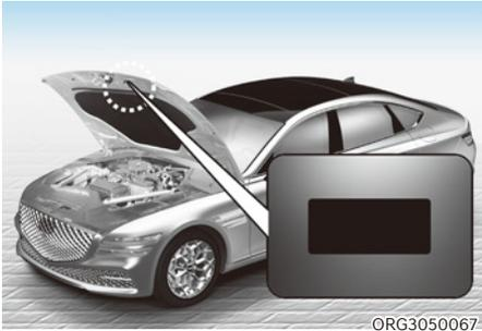
**Étiquette du fluide réfrigérant de climatisation**
