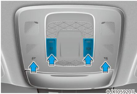
**Liseuse avant** (☰ ☱) : Appuyez sur l'une des icônes pour allumer ou éteindre la liseuse. Cette lumière produit un faisceau étroit, commode pour lire des cartes la nuit ou comme lampe personnelle pour le conducteur et le passager avant.
