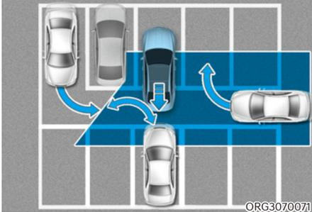
Le système de sécurité de circulation transversale à l'arrière peut détecter des véhicules qui se garent ou quittent un emplacement à proximité de votre véhicule (par ex. un véhicule qui s'en va à côté du vôtre, un véhicule qui se gare ou quitte un emplacement à l'arrière, un véhicule qui approche du vôtre en tournant, etc.). Si cela se produit, le système peut avertir inutilement le conducteur.
