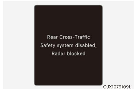
Lorsque le pare-chocs arrière ou du détecteur est recouvert de corps étrangers, comme de la neige ou de la pluie, ou lorsqu'on attache une remorque ou un porte-vélos, cela peut réduire les performances de détection et limiter ou désactiver temporairement le système de sécurité de circulation transversale à l'arrière.
