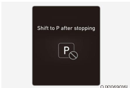
Ce message s'affiche quand le mode P (Stationnement) est sélectionné alors que le véhicule est en mouvement.
