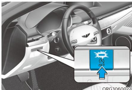
Appuyez sur le bouton de désactivation ISG OFF pour désactiver le système ISG. Le témoin du bouton de désactivation du système ISG s'allume. Pour utiliser le système, appuyez à nouveau sur le bouton ISG OFF.
