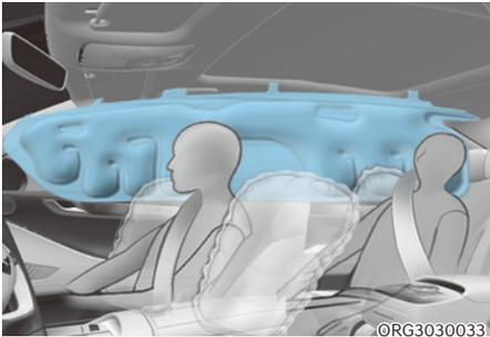
Les airbags rideaux sont situés des deux côtés des longerons de toit, au dessus des portes avant et arrière.
