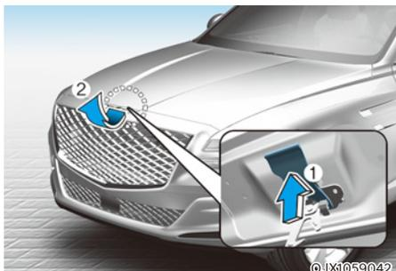
3. Allez à l'avant du véhicule, soulevez légèrement le capot, poussez le loquet de sécurité (1) vers le haut au centre du capot et soulevez le capot (2).
