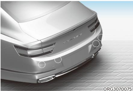
Les capteurs ultrasons arrière sont situés à l'intérieur du pare-chocs arrière pour détecter les objets à l'arrière. Si les capteurs sont recouverts de corps étrangers (neige, pluie...), cela peut nuire aux performances des capteurs et l'assistance d'évitement de collision de stationnement en marche arrière pourrait ne pas fonctionner normalement. Veillez à toujours garder le pare-chocs propre.
