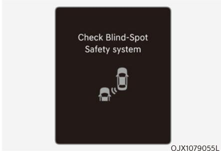
Lorsque le système de sécurité d'angle mort ne fonctionne pas correctement, le message 'Check Blind-Spot Safety system (Vérifiez le système de sécurité d'angle mort)' apparaît dans le combiné d'instruments et le système se désactive automatiquement, ou il sera limité. Nous vous conseillons de faire inspecter le système par un concessionnaire Genesis agréé.
