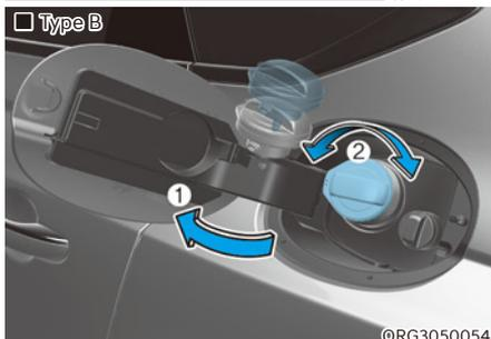
4. Ouvrez la trappe à carburant (1) pour accéder au bouchon du réservoir de carburant.
