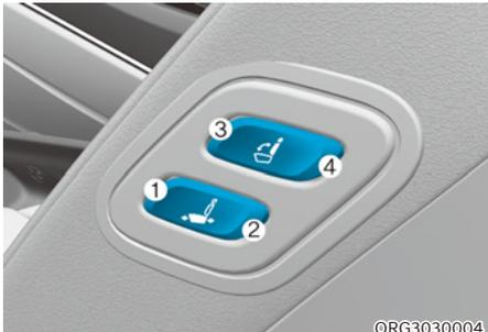
Le passager assis à l'arrière peut utiliser les commutateurs pour contrôler la position du siège du passager avant.
