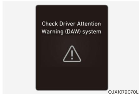
Lorsque le système d'avertissement d'attention du conducteur ne fonctionne pas correctement, le message « Check Driver Attention Warning (DAW) system » (Vérifiez le système de détection de fatigue du conducteur (DAW)) apparaît dans le combiné d'instruments. Dans ce cas, nous vous recommandons de faire inspecter le système par un concessionnaire Genesis agréé.
