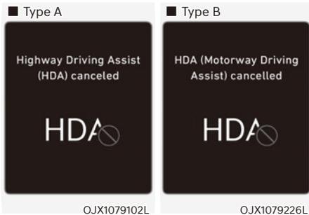
Si le conducteur n'a toujours pas les mains sur le volant après le rappel, le message « Highway Driving Assist (HDA) canceled » (Assistance à la conduite sur autoroute annulée) (ou « HDA (Highway Driving Assist) cancelled ») apparaîtra et l'assistance à la conduite sur autoroute et l'assistance au changement de file seront automatiquement annulées.
