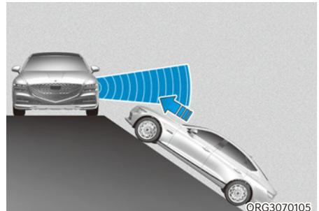
Le système de sécurité de circulation transversale à l'arrière peut être limité lorsque le véhicule est dans une montée ou une descente ou s'en approche, et peut ne pas détecter le véhicule s'approchant par la gauche ou la droite. Si c'est le cas, le système peut ne pas avertir le conducteur ou intervenir sur les freins lorsque cela est nécessaire.
