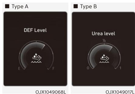
La jauge de niveau DEF (liquide d'échappement diesel) indique la quantité restante approximative de solution d'urée dans le réservoir.
