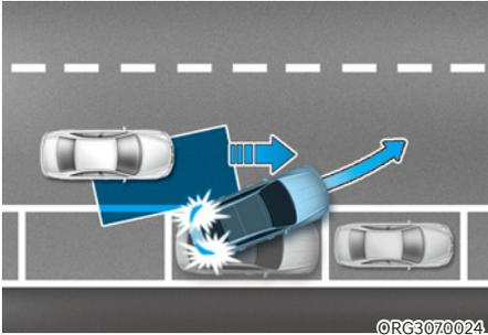
Lorsque vous sortez d'un espace de stationnement en marche avant, si le système juge qu'il y a un risque de collision avec un véhicule qui approche dans l'angle mort, le système vous aidera à éviter la collision en appliquant les freins.
