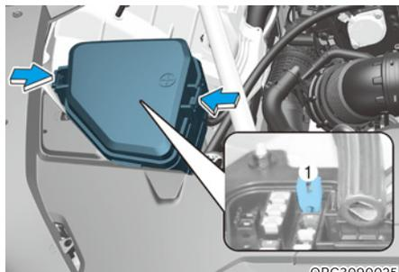
5. Tirez le fusible suspect droit. Utilisez l'outil de dépose (1) fourni dans le couvercle du panneau des fusibles du compartiment moteur.
