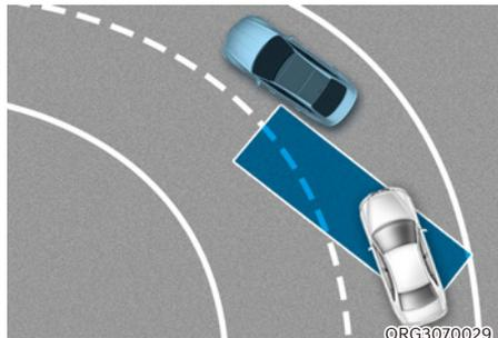
Le système de sécurité d'angle mort peut ne pas fonctionner correctement lorsque vous conduisez sur une route sinueuse. Le système peut ne pas détecter un véhicule dans la même voie.
