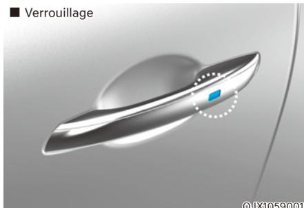
Touchez le capteur tactile sur la poignée de porte extérieure avant (la partie gravée) tout en portant la clé intelligente sur vous ou appuyez sur le bouton de verrouillage de la porte de la clé intelligente. Toutes les portes se verrouillent.
