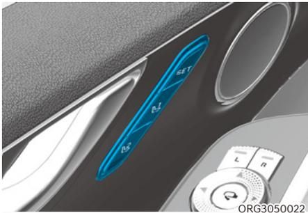
Le système de mémoire intégré pour le siège du conducteur est fourni pour stocker et rappeler les paramètres de mémoire suivants avec une simple opération de bouton.
