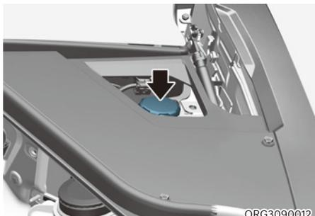
Vérifier périodiquement le niveau du liquide dans le réservoir. Le niveau du liquide doit se trouver entre les repères MAX et MIN sur le côté du réservoir.
