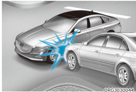
Les airbags frontaux peuvent ne pas se déployer lors de collisions latérales, car les occupants étant projetés dans la direction de la collision, ils n'apporteraient aucune protection supplémentaire en cas de choc latéral.
