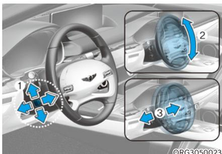
Pour modifier l'angle et la hauteur du volant :
