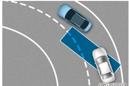
Le système de sécurité d'angle mort peut ne pas fonctionner correctement lorsque vous conduisez sur une route sinueuse. Le système peut ne pas détecter le véhicule dans la même voie.
