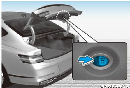
Votre véhicule est équipé d'un levier de déverrouillage d'urgence du coffre situé à l'intérieur du coffre. Lorsque quelqu'un verrouille par inadvertance le coffre, le coffre peut être ouvert en déplaçant le levier dans le sens de la flèche et en appuyant sur le coffre pour l'ouvrir.
