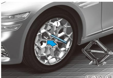
10. Introduisez la broche de centrage (1) dans le trou où se trouvait le boulon. Déposez le reste des boulons de la roue.
