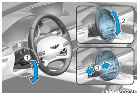
Pour régler l'angle et la hauteur du volant :
