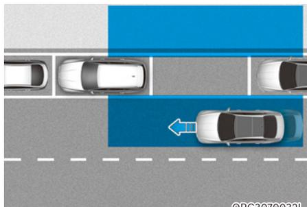
Après l'arrêt du véhicule, si un véhicule venant de derrière est détecté alors qu'un passager ouvre une portière, l'alerte de sortie en sécurité prévient le conducteur par un message d'avertissement et un signal sonore pour éviter un impact.
