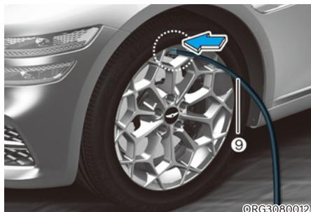
1. Branchez le tuyau (9) du compresseur directement sur la valve du pneu.
