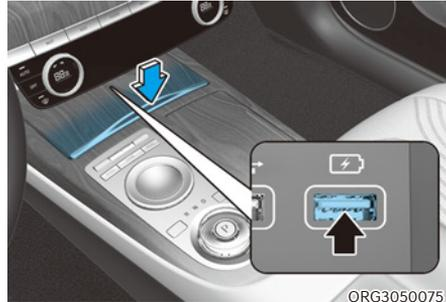
Le chargeur USB permet de recharger les batteries de petits appareils électriques à l'aide d'un câble USB.
