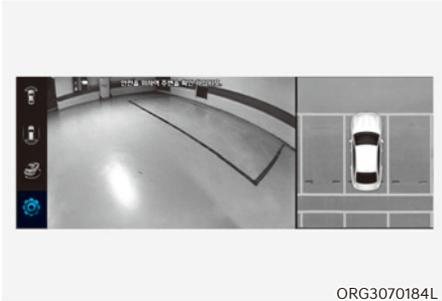
Vous pouvez modifier les paramètres de la vue panoramique en appuyant sur l'icône de configuration (⚙️) sur l'écran lorsque le système fonctionne ou sélectionnez 'Driver Assistance → Parking Safety → Camera Settings' dans le menu Réglages lorsque le bouton de démarrage/d'arrêt du moteur est en position ON.
