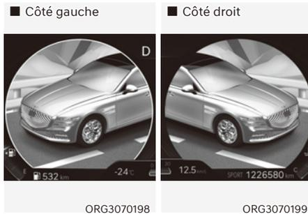
La visualisation de l'angle mort affiche la zone d'angle mort arrière du véhicule dans le combiné d'instruments lorsque le clignotant est allumé pour aider à changer de voie en toute sécurité.
