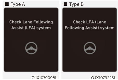
Lorsque l'assistance au suivi de voie ne fonctionne pas correctement, le message 'Check Lane Following Assist (LFA) system (Contrôlez le système d'assistance au suivi de voie)' (ou 'Check LFA (Lane Following Assist) system (Contrôlez le LFA)') apparaîtra et le témoin s'allumera en jaune dans le combiné d'instruments. Dans ce cas, nous vous recommandons de faire inspecter le système par un concessionnaire Genesis agréé.
