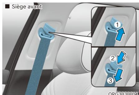
Pour régler la hauteur du point d'ancrage de la ceinture de sécurité, montez ou descendez le point d'ancrage jusqu'à la position souhaitée.
