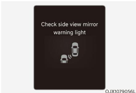
Lorsque le témoin du rétroviseur extérieur ne fonctionne pas correctement, le message 'Check side view mirror warning light (Vérifiez le témoin du rétroviseur extérieur)' apparaît dans le combiné d'instruments. Nous vous conseillons de faire inspecter le système par un concessionnaire Genesis agréé.
