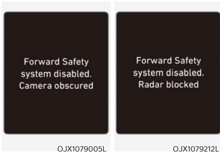
Lorsque le pare-brise avant où se trouve la caméra avant, le cache du radar avant, le pare-chocs ou le détecteur sont couverts de neige ou de pluie par exemple, cela peut réduire les performances de détection et limiter ou désactiver temporairement le freinage d'urgence autonome.
