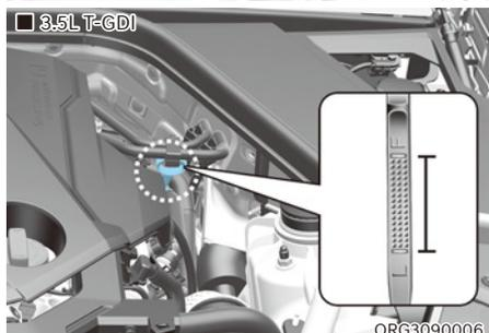
6. Retirez de nouveau la jauge et vérifiez le niveau. Le niveau doit être compris entre F (Plein) et L (Faible).
