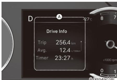
Les modes d'affichage Assistance à la conduite, Vir. par virage et Utilitaire s'affichent au centre (A) du combiné d'instruments.
