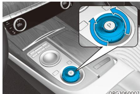
Pour sélectionner la position N (Point mort), tournez le sélecteur rotatif dans le sens des aiguilles d'une montre depuis la position R (Marche arrière) ou dans le sens contraire depuis la position D (Conduite) tout en enfonçant la pédale de frein.
