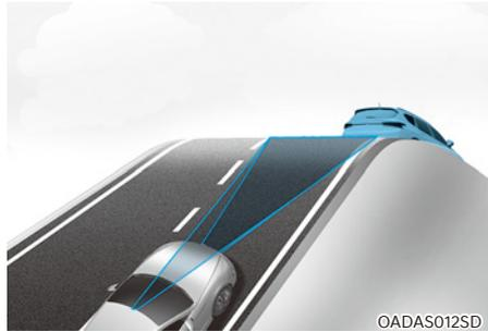
En montée ou en descente, le régulateur de vitesse intelligent peut ne pas détecter un véhicule en mouvement dans votre voie et votre véhicule alors accélérera alors jusqu'à la vitesse programmée. De même, la vitesse du véhicule diminuera rapidement lorsque le véhicule devant est détecté soudainement.
