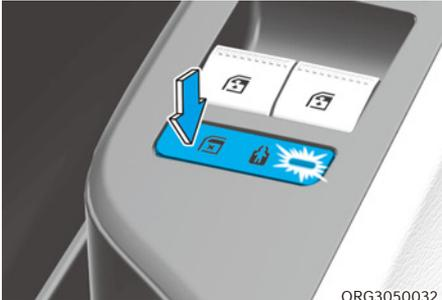
Le conducteur peut désactiver les commutateurs de lève-vitre électrique sur les portes arrière des passagers en appuyant sur le bouton de verrouillage de lève-vitre électrique.
