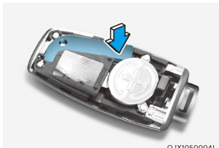
2. Appuyez sur la clé mécanique et retirez-la de la clé intelligente.
