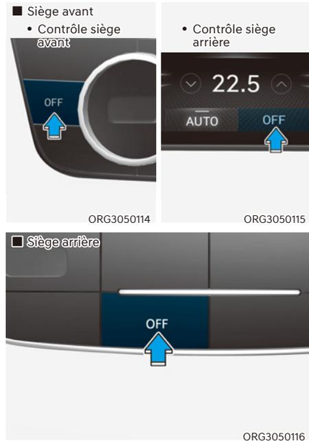
Appuyez sur l'icône ou le bouton OFF pour désactiver le système de climatisation. Vous pouvez toujours utiliser les boutons de mode et d'admission d'air tant que le bouton de démarrage/arrêt du moteur est en position ON.
