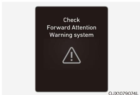
Lorsque l'avertissement d'attention du conducteur ne fonctionne pas correctement, le message 'Check Forward Attention Warning system (Vérifiez le système d'avertissement d'attention du conducteur)' apparaît dans le combiné d'instruments. Dans ce cas, nous vous recommandons de faire inspecter le système par un concessionnaire Genesis agréé.
