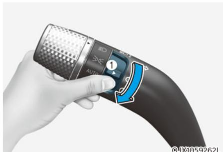
Pour allumer les feux antibrouillard arrière : Placez le commutateur des phares sur la position phares, puis le commutateur des phares (1) sur la position Feu antibrouillard arrière.
