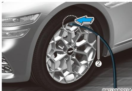
3. Dévissez le bouchon de la valve du pneu défectueux et vissez le tuyau de remplissage (2) de la bouteille de produit d'étanchéité sur la valve.
