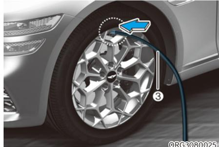
4. Dévisser le capuchon de valve de la roue défectueuse et visser le flexible de remplissage (3) du flacon de produit d'étanchéité sur la valve.
