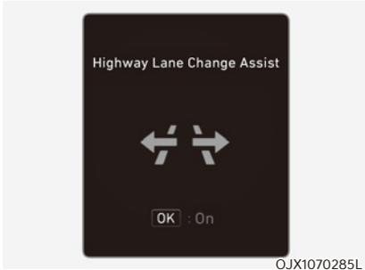
Le bouton OK est enfoncé sur le volant lorsqu'un message sur le combiné d'instruments demande si la fonction de changement de file sur autoroute est utilisée ou non.
