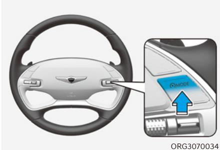
Appuyez sur le bouton **MODE** pour désactiver le système d'assistance manuelle à la limite de vitesse. L'indicateur de limite de vitesse (**LIMIT**) s'éteindra.
