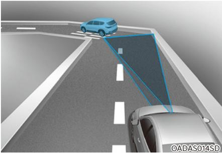
Dans les virages, le régulateur de vitesse adaptatif peut ne pas détecter un véhicule dans votre voie et pourrait alors accélérer jusqu'à la vitesse de consigne. De même, la vitesse du véhicule peut rapidement diminuer lorsque le véhicule devant est détecté soudainement.
