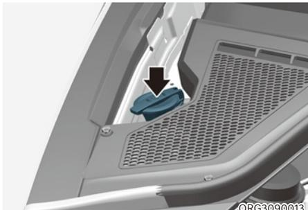
Vérifiez le niveau et ajoutez du liquide lave-glace dans le réservoir si nécessaire. Vous pouvez utiliser de l'eau plate si vous ne disposez pas de liquide lave-glace. Dans ce cas, utilisez un produit nettoyant antigel si le climat est froid pour éviter le gel.
