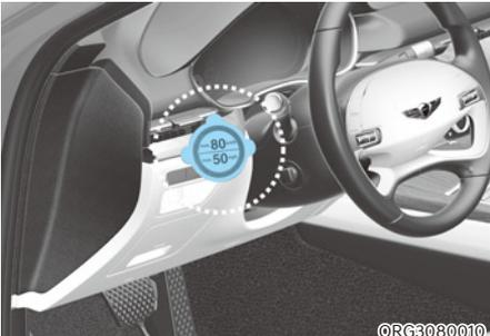
Retirez l'étiquette de limitation de vitesse (1) de la bouteille de produit d'étanchéité (2) et placez-la à un endroit bien visible à l'intérieur du véhicule, par exemple sur le volant, pour rappeler au conducteur de ne pas conduire trop vite.
