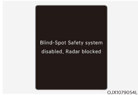
Lorsque le pare-chocs arrière autour du radar d'angle arrière ou du détecteur est recouvert de corps étrangers, comme de la neige ou de la pluie, ou lorsqu'on attache une remorque ou un porte-vélos, cela peut réduire les performances de détection et limiter ou désactiver temporairement le système de sécurité d'angle mort.
