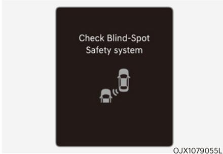
Lorsque le système de sécurité d'angle mort ne fonctionne pas correctement, le message 'Check Blind-Spot Safety system (Vérifiez le système de sécurité d'angle mort)' apparaît dans le combiné d'instruments et le système se désactive automatiquement, ou il sera limité. Nous vous conseillons de faire inspecter le système par un concessionnaire Genesis agréé.
