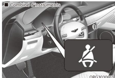
Le témoin de la ceinture de sécurité sert de rappel au conducteur : il s'allume pendant environ 6 secondes à chaque fois que le bouton de démarrage/d'arrêt du moteur est en position ON ou START, que la ceinture soit attachée ou non.
