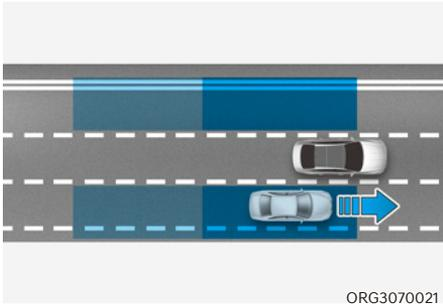
Le système d'avertissement de collision d'angle mort détecte et informe le conducteur qu'un véhicule se trouve dans l'angle mort.
