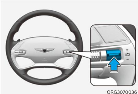
Appuyez sur le bouton **LIMIT** pour annuler provisoirement la limite de vitesse définie. La limite de vitesse définie se désactivera, mais l'indicateur de la limite de vitesse (LIMIT) restera visible.
