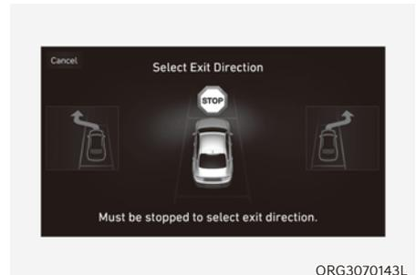
Lorsque le véhicule est arrêté à l'aide de la pédale de frein, touchez l'écran du système d'infodivertissement ou utilisez le dispositif de commande centrale pour sélectionner le sens de sortie souhaité.
