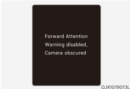
Lorsqu'il y a un objet juste devant la caméra ou entre le conducteur et la caméra pendant un certain temps, l'avertissement d'attention du conducteur ne fonctionne pas correctement et le message 'Forward Attention Warning disabled. Camera obscured (Avertissement d'attention du conducteur désactivé. Caméra obstruée)' apparaîtra dans le combiné d'instruments.
