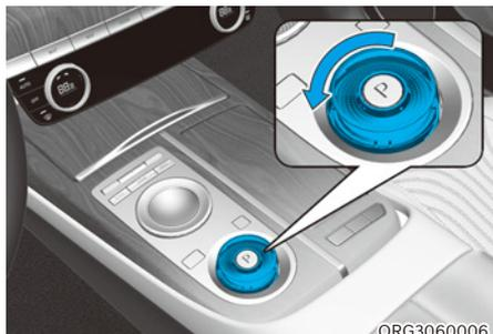
Pour sélectionner la position R (Marche arrière), tournez le sélecteur rotatif dans le sens contraire des aiguilles d'une montre tout en enfonçant la pédale de frein.
