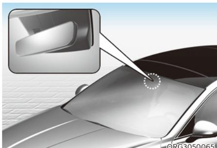
**Ne placez aucun objet à proximité du capteur de lumière ambiante/solaire pour garantir un contrôle optimal du système de chauffage et de refroidissement.**
