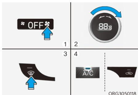
1. Réglez la vitesse du ventilateur sur la position maximale (la plus à droite).
