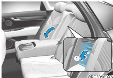
Lorsque la batterie du véhicule est déchargée ou que le coffre doit être ouvert manuellement :
