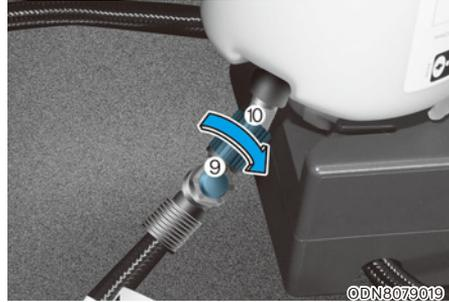
2. Visser le flexible de connexion (10) sur le raccord du flacon de produit d'étanchéité.
