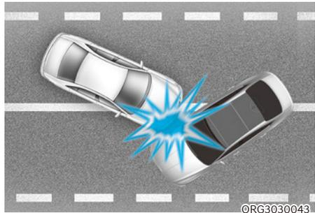
Lors d'une collision angulaire, la force de l'impact peut projeter les occupants dans une direction dans laquelle les airbags ne présenteraient aucun avantage, et les capteurs peuvent donc ne pas les déployer.
