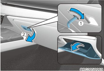
La boîte à gants peut être verrouillée et déverrouillée avec la clé mécanique (1).
