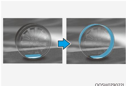
10. Roulez immédiatement sur environ 7-10 km (4-6 miles ou pendant environ 10 minutes) pour répartir uniformément le produit d'étanchéité dans le pneu.
