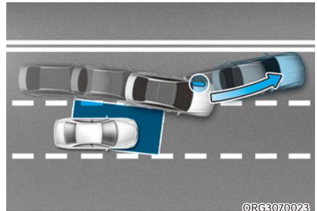
Lors du changement de voie en détectant la voie devant, si le système juge qu'il y a un risque de collision avec un véhicule qui approche dans l'angle mort, le système aidera à éviter la collision en appliquant les freins.
