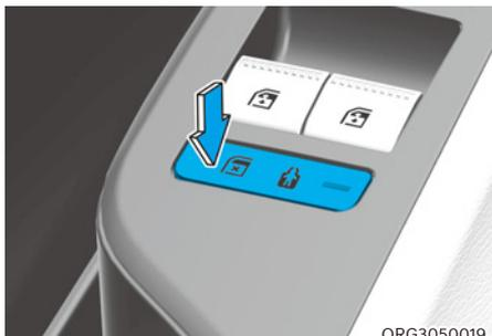
Lorsque le bouton de verrouillage électronique de sécurité pour enfants est enfoncé et que le témoin lumineux du bouton s'allume, les portes arrière ne peuvent pas être ouvertes de l'intérieur du véhicule.
