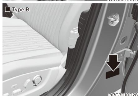
L'étiquette de certification du véhicule fixée au pied milieu du côté conducteur (ou passager avant) indique le numéro d'identification du véhicule (VIN).
