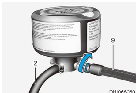
2. Vissez le tuyau de connexion (9) sur le connecteur de la bouteille de produit d'étanchéité.
