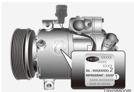
Une étiquette indique le type du compresseur de votre véhicule, avec le modèle, la référence du fournisseur, le numéro de production, le réfrigérant (1) et l'huile réfrigérante (2).
