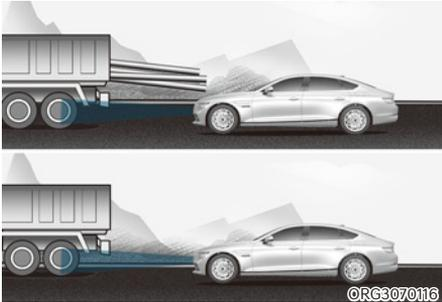
Dans les cas suivants, le véhicule devant ne peut pas être détecté par le capteur :
