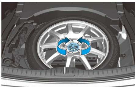
Tournez le boulon de maintien à ailettes dans le sens antihoraire pour dégager la roue de secours.
