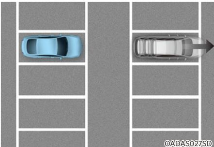
Si un véhicule garé devant s'éloigne de vous, l'alerte de démarrage du véhicule de tête peut vous avertir que le véhicule garé s'éloigne.
