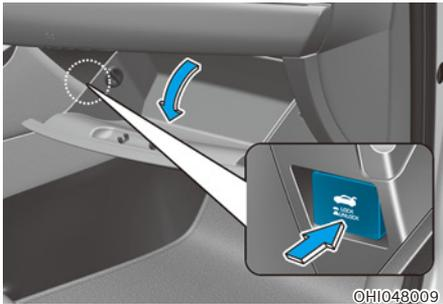
Lorsque le bouton de commande de couvercle de coffre est en position UNLOCK (bouton non enfoncé), le coffre électrique peut être contrôlé avec le bouton de commande principale de coffre électrique, le contacteur d'ouverture de coffre électrique, le bouton de fermeture de coffre électrique et la clé intelligente.
