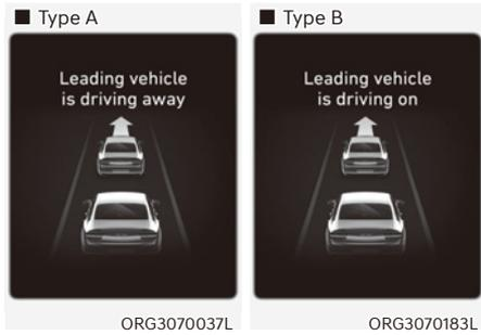
Lorsque le véhicule de tête quitte l'arrêt, l'alerte de démarrage du véhicule de tête avertit le conducteur en affichant le message 'Leading vehicle is driving away (Le véhicule de tête démarre)' (ou 'Leading vehicle is driving on (Le véhicule de tête continue à démarrer)') dans le combiné d'instruments et un signal sonore retentit.
