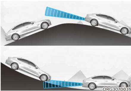
Le système de sécurité d'angle mort peut ne pas fonctionner correctement lorsque vous roulez en montée ou en descente. Le système peut ne pas détecter le véhicule dans la voie adjacente ou peut détecter incorrectement le sol ou la structure.
