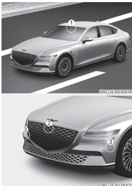
[1] : Caméra frontale, [2] : Radar avant [3] : radar d'angle avant (si équipé)
