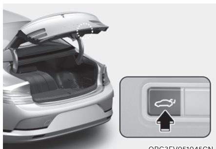
3. Bouton de fermeture de coffre électrique
