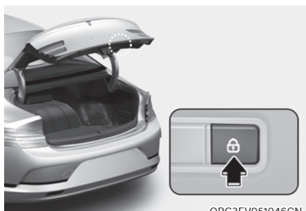
4. Bouton de verrouillage de coffre électrique
