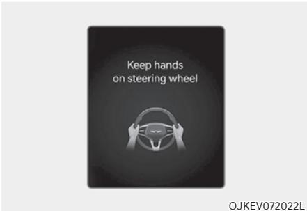
Si le conducteur retire ses mains du volant pendant plusieurs secondes, le message « Gardez les mains sur le volant » apparaît et un signal sonore retentit par phases.
