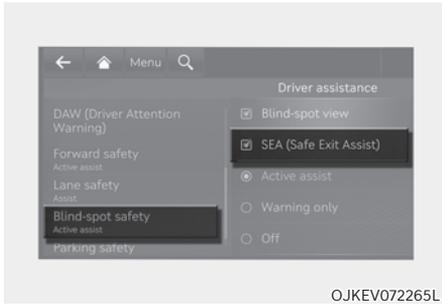
Véhicule allumé, sélectionnez « Assistance au conducteur → Sécurité angle mort → Assistance de sortie d'urgence » dans le menu Réglages pour activer l'aide à la sortie sécurisée et désélectionnez pour désactiver le système.
