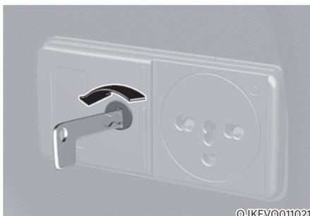
2. Déverrouillez le cache de la prise d'alimentation à l'aide de la clé connectée.
