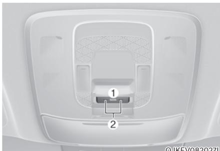
Composantes du système eCall paneuropéen installé dans l'habitacle :
