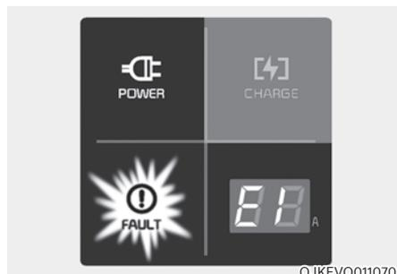
Avant de brancher le connecteur de charge sur le véhicule (POWER : vert fixe, FAULT : rouge clignotant)
