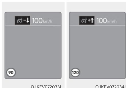
Si la limite de vitesse de la route change lorsque l'assistance manuelle de limite de vitesse ou le régulateur de vitesse intelligent fonctionne, une flèche allant vers le haut ou vers le bas s'affiche pour informer le conducteur que la vitesse réglée doit être changée. À ce moment, le conducteur peut modifier la vitesse réglée en fonction de la limite de vitesse à l'aide du contacteur + ou - au volant.
