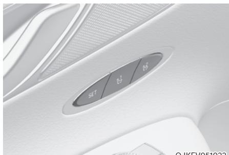
Le système de mémoire intégré pour le siège du conducteur est fourni pour stocker et rappeler les paramètres de mémoire suivants avec une simple opération de bouton.
