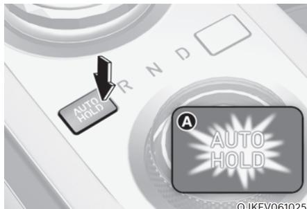
1. Lorsque la portière du conducteur et le capot sont fermés, enfoncez la pédale de frein, puis sur le commutateur AUTO HOLD. Le témoin AUTO HOLD blanc s'allume et le système se met en veille.
