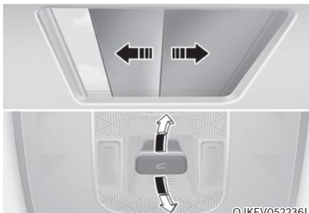
Le pare-soleil électrique permet de bloquer les rayons du soleil au niveau du toit ouvrant.
