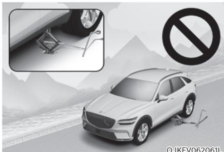
**Ne démarrez jamais ou ne faites pas tourner le moteur d'un véhicule sur un véhicule AWD monté sur un cric. Le véhicule peut glisser ou tomber du cric et entraîner des blessures graves ou mortelles pour vous ou les personnes qui se trouvent à proximité.**
