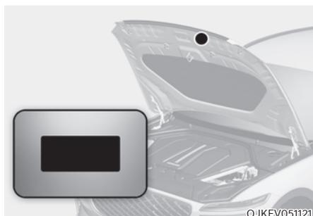
Vous pouvez identifier le liquide réfrigérant du système de climatisation utilisé dans votre véhicule en consultant l'étiquette située à l'intérieur du capot.
