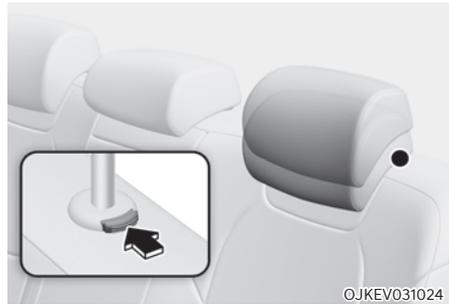
2. Abaissez les appui-têtes arrière à la position la plus basse.
