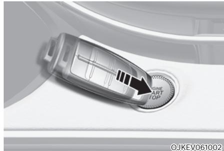
Si la pile de la clé connectée est faible ou si la clé connectée ne fonctionne pas correctement, vous pouvez démarrer le véhicule en appuyant sur le bouton Start/Stop (démarrage/arrêt), avec la clé connectée dirigée comme le montre l'image ci-dessus.
