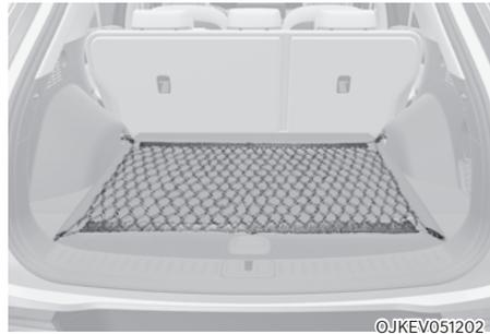
Pour éviter que les objets dans le compartiment à bagages ne se déplacent, vous pouvez utiliser les 4 supports situés dans le couvre-bagages pour fixer le filet à bagages.
