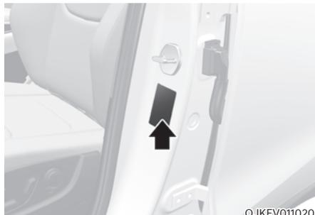
L'étiquette de certification du véhicule fixée au pied milieu du côté conducteur (ou passager avant) indique le numéro d'identification du véhicule (VIN).
