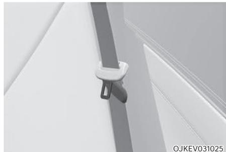
3. Faites passer la sangle de la ceinture de sécurité à travers les guides de ceinture de sécurité arrière pour éviter que les ceintures ne se coincent derrière ou sous les sièges.
