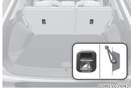
Les ancrages de fixation supérieure pour les systèmes de retenue pour enfants sont situés sur l'arrière des dossiers de siège.
