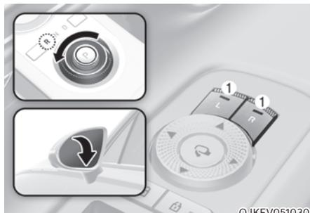
Lorsque le rapport est mis en position R (marche arrière), le ou les rétroviseurs extérieurs pivotent vers le bas pour faciliter la marche arrière.
