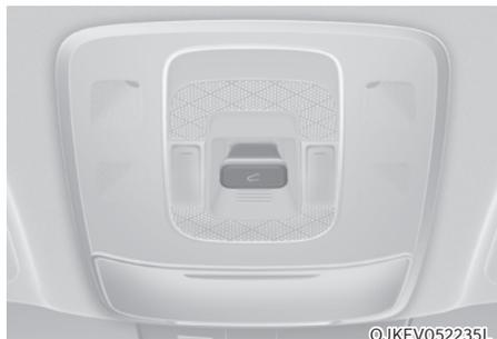
Le toit ouvrant ne peut être manipulé que lorsque le bouton de démarrage/arrêt du moteur est en position ON ou START.
