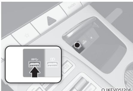
Vous pouvez utiliser un câble USB pour brancher des appareils audio au port USB du véhicule.
