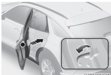
En cas d'urgence, par exemple lorsque la batterie est déchargée, la seule façon de verrouiller la ou les portes est d'utiliser la clé mécanique depuis le trou de clé extérieur.
