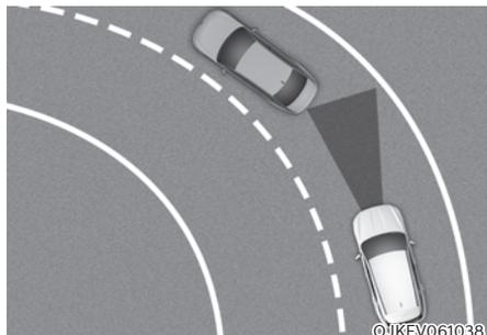
Les capteurs avant peuvent être incapables de reconnaître le véhicule précédent si vous êtes en roue libre dans un virage. L'intensité du freinage par régénération peut être automatiquement réduite, ce qui peut accélérer le véhicule.
