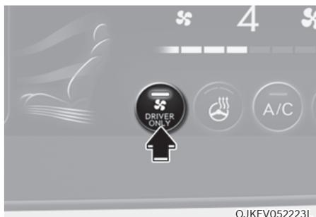
Si vous appuyez sur l'icône DRIVER ONLY (conducteur uniquement) (☹️ DRIVER ONLY) et que le témoin s'allume sur l'écran de commande de la climatisation du système d'infodivertissement, l'air froid souffle principalement dans la direction du siège du conducteur. Toutefois, un peu d'air froid peut sortir des conduits des autres sièges pour maintenir une atmosphère agréable.
