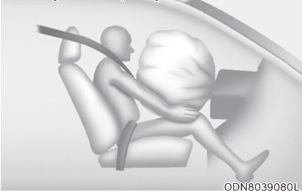
Après son déploiement complet, l'airbag commence immédiatement à se dégonfler, ce qui permet au conducteur de garder une certaine visibilité et de tourner le volant ou d'actionner d'autres commandes.
