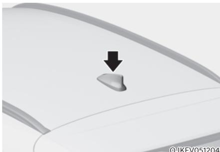
L'antenne en aileron de requin permet de recevoir les émissions AM, FM et de transmettre des données.
