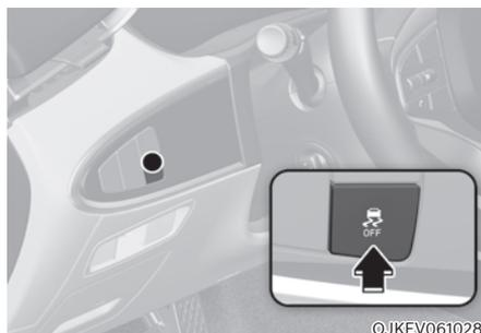
Le contrôle électronique de stabilité (ESC) assure la stabilité de votre véhicule dans les virages. L'ESC vérifie l'angle de braquage et la trajectoire du véhicule.
