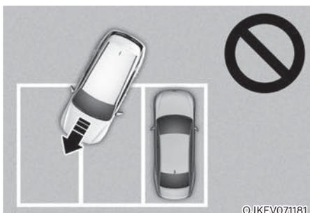
Si l'aide au stationnement intelligent est utilisée lorsque le stationnement dans une place de stationnement avec un véhicule d'un côté uniquement, votre véhicule peut rouler sur la ligne de l'emplacement pour éviter le véhicule stationné.
