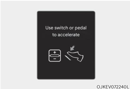
Dans la circulation, votre véhicule s'arrêtera si le véhicule qui vous précède s'arrête. Également, si le véhicule qui précède démarre, votre véhicule démarrera aussi. En outre, une fois le véhicule arrêté et un certain temps écoulé, le message « Utilisation bouton ou pédale pour accélérer » s'affichera dans le combiné d'instruments.
