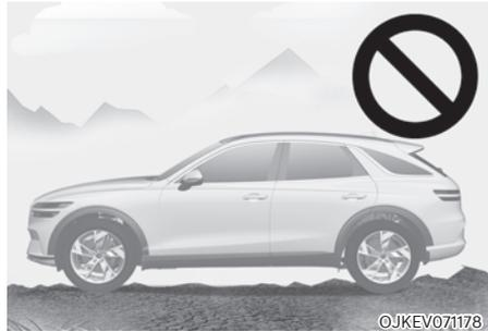
L'aide au stationnement intelligent à distance peut être annulée lorsque le véhicule dérape ou que le véhicule ne peut pas se déplacer en raison de l'état de la route comme des cailloux ou des pierres fragmentées.
