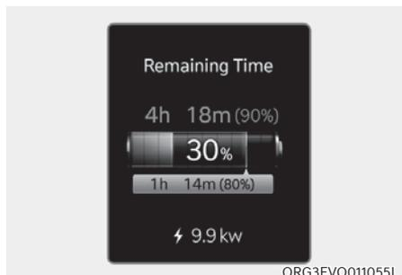
8. Après le début de la mise en charge, le temps de charge estimé s'affiche sur le combiné d'instruments pendant environ 1 minute.
