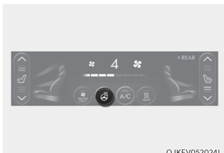
Lorsque le témoin READY (PRÊT) est allumé, touchez l'icône du volant chauffant pour chauffer le volant.
