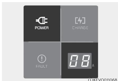
2. Vérifiez si le témoin d'alimentation (vert) s'allume sur le boîtier de commande.
