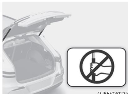
Ne jamais tenir ou s'accrocher aux entretoises de support du hayon. Les entretoises de support du hayon pourraient être endommagées. La déformation des entretoises de support du hayon peut endommager le véhicule et causer des blessures.
