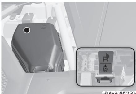
Abaissez le levier jaune de l'interrupteur de coupure haute tension pour couper la batterie haute tension.
