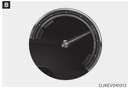
La jauge de puissance/charge indique la consommation d'énergie et l'état de récupération du moteur électrique.
