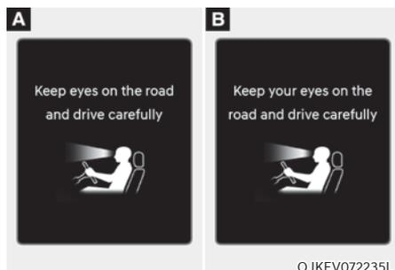
L'avertissement d'attention du conducteur détermine si le conducteur est concentré sur la route, comme le temps passé à regarder ailleurs, la durée de fermeture des yeux, la fréquence des bâillements, etc. Si le conducteur n'est pas concentré, le message d'avertissement « Regardez la route et conduisez prudemment » (ou « Gardez les yeux sur la route et conduisez prudemment ») s'affiche sur le combiné et un avertissement sonore retentit.
