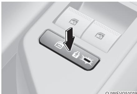
Lorsque le bouton de verrouillage électronique de sécurité pour enfants est enfoncé et que le témoin lumineux du bouton s'allume, les portes arrière ne peuvent pas être ouvertes de l'intérieur du véhicule.
