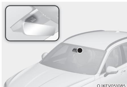
Le désembuage automatique permet de réduire la probabilité de formation de buée sur la face intérieure du pare-brise en détectant le taux d'humidité.
