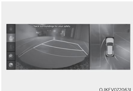
L'image arrière s'affiche à l'écran lorsque le rapport est en P (stationnement) pour aider au stationnement. Le bouton de visualisation (2) vous permet de sélectionner la vue arrière, la vue de face, la vue latérale et la vue 3D.
