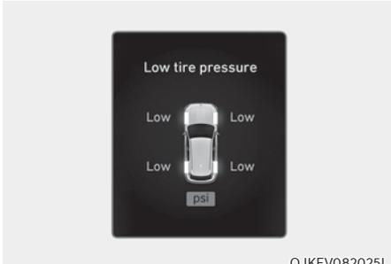
Lorsque les témoins d'avertissement du système de surveillance de la pression des pneus s'allument et qu'un message d'avertissement s'affiche sur l'écran LCD du combiné, un ou plusieurs de vos pneus sont nettement sous-gonflés. Le témoin d'identification de pneus sous-gonflés indique le pneu qui est nettement sous-gonflé en éclairant la position correspondante.
