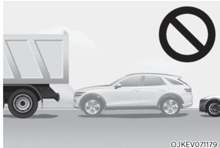
N'utilisez pas l'aide au stationnement intelligent à distance autour de véhicules dont la garde au sol est plus élevée, comme un bus, un camion, etc. Cela peut entraîner un accident.
