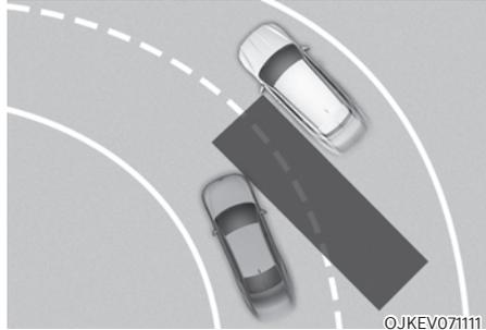
**L'aide à l'évitement de collision d'angle mort peut ne pas fonctionner correctement dans les courbes. La fonction peut ne pas détecter le véhicule dans la voie adjacente.**
