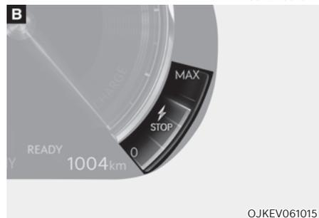
Le niveau de freinage régénératif sélectionné est affiché sur le combiné d'instruments. Lorsque le véhicule est éteint et remis en marche après que le niveau de freinage par récupération ait été abaissé à 0 ou à i-PEDAL, le niveau de freinage passe à 1.
