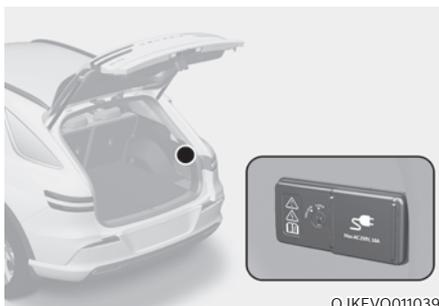
1. Branchez la prise de courant située sur le côté inférieur droit du hayon avec le bouton Stop/Start du véhicule en position ON.
