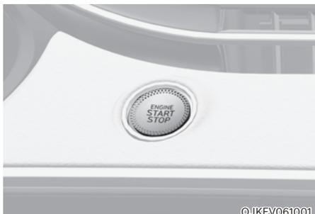
Lorsque la porte avant est ouverte, le bouton Start/Stop (démarrage/arrêt) s'allume et s'éteint 30 secondes après la fermeture de la porte.
