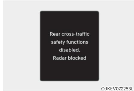
Lorsque le pare-chocs arrière autour du radar arrière ou du détecteur est recouvert de corps étrangers, comme de la neige ou de la pluie, ou lorsqu'on attache une remorque ou un porte-vélos, cela peut réduire les performances de détection et limiter ou désactiver temporairement l'aide à l'évitement de collision avec la circulation transversale à l'arrière.
