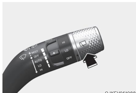
Repoussez le levier pour pulvériser du liquide lave-glace à l'arrière et pour actionner l'essuie-glace arrière sur 1-3 cycles. La pulvérisation et les essuie-glaces continuent à fonctionner jusqu'à ce que vous relâchiez le levier.
