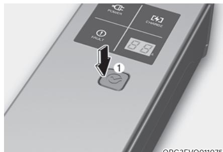
4. Appuyez sur le bouton (1) situé à l'avant du boîtier de commande pendant 2 à 8 secondes pour régler le niveau de charge. (Consultez le type de câble de charge et les exemples de réglage du niveau de charge.)
