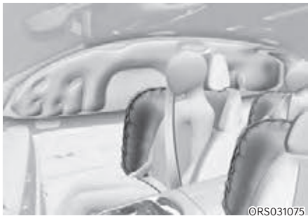
[A] : Airbag latéral (rangée avant), [B] : Airbag latéral (deuxième rangée), [C] : airbag latéral central avant (siège du conducteur)
