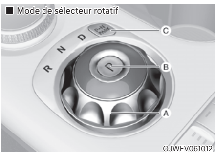
[A] : Sélecteur rotatif (molette de sélecteur de vitesse), [B] : Bouton P, [C] : Capuchon de libération P
