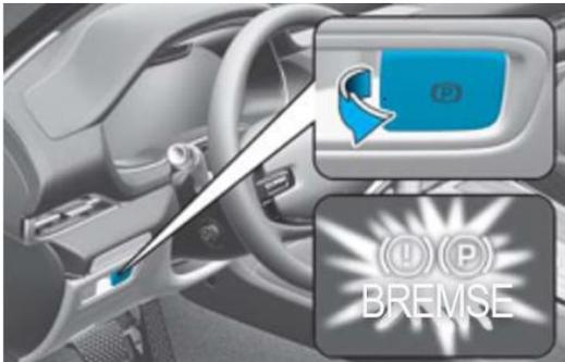
1. Unterlegkeile unterlegen und Schalter herausziehen, um Feststellbremse zu betätigen.
